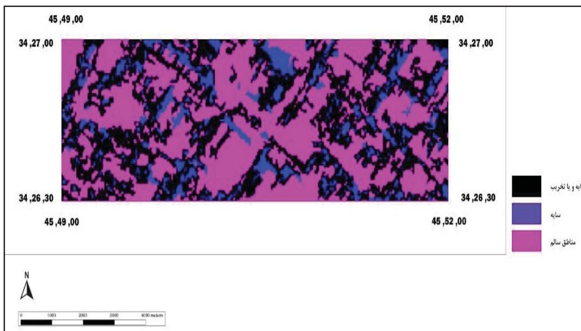
شکل ۳: نتایج طبقه‌بندی نظارت نشده با استفاده از الگوریتم ایزودیتا بر روی ساختمان استخراج شده
