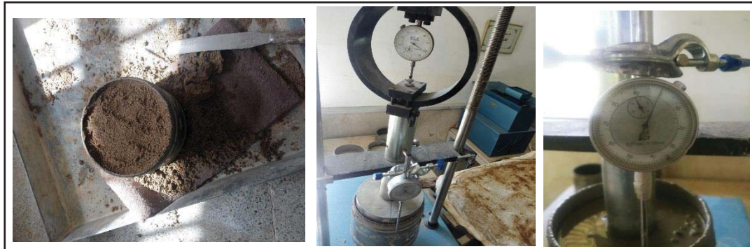
شکل ۴: نمونه خاک ماسه در آزمایشگاه در حالت آزمایش تعیین مقاومت CBR اشباع
