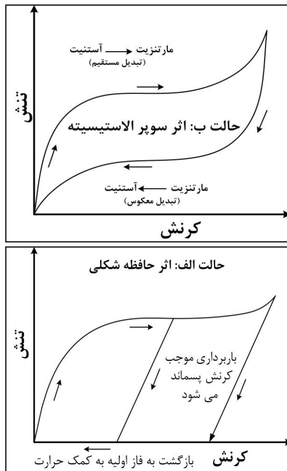
شکل ۱. منحنی تنش-کرنش خاصیت فوق ارتجاعی و حافظه شکلی (شهناز، ۲۰۱۵)
