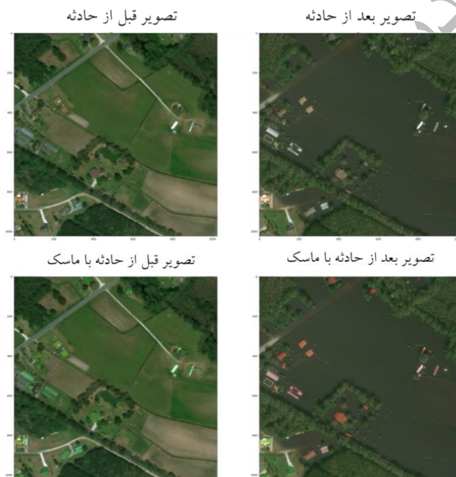
شکل (۳): نمونه‌هایی از تصاویر مجموعه داده مرجع xBD برای ارزیابی خسارت ساختمان‌ها. این تصاویر شامل حالت‌های 'قبل از حادثه' و 'بعد از حادثه' هستند که به صورت جفت ارائه شده‌اند. ماسک‌های سگمنتیشن نشان‌دهنده چهار رده خسارت تعریف‌شده (شامل بدون آسیب، آسیب کم، آسیب زیاد و تخریب کامل) هستند که در فاز آموزش و ارزیابی مدل به کار رفته‌اند.
