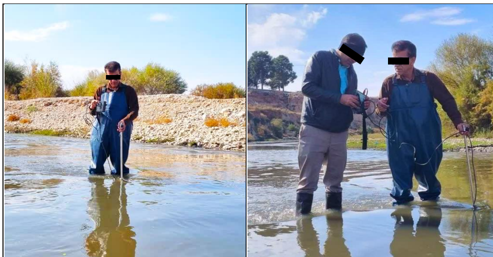
تصویر ۵. نحوه اندازه‌گیری سرعت جریان در بازه مکانی مورد مطالعه
