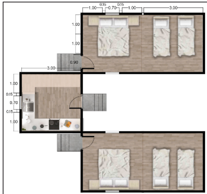
شکل ۱۴. پلان پیشنهادی برای دو خانواده ۴ نفره با آشپزخانه مشترک به مساحت ۴۵ متر مربع (نگارنده)
