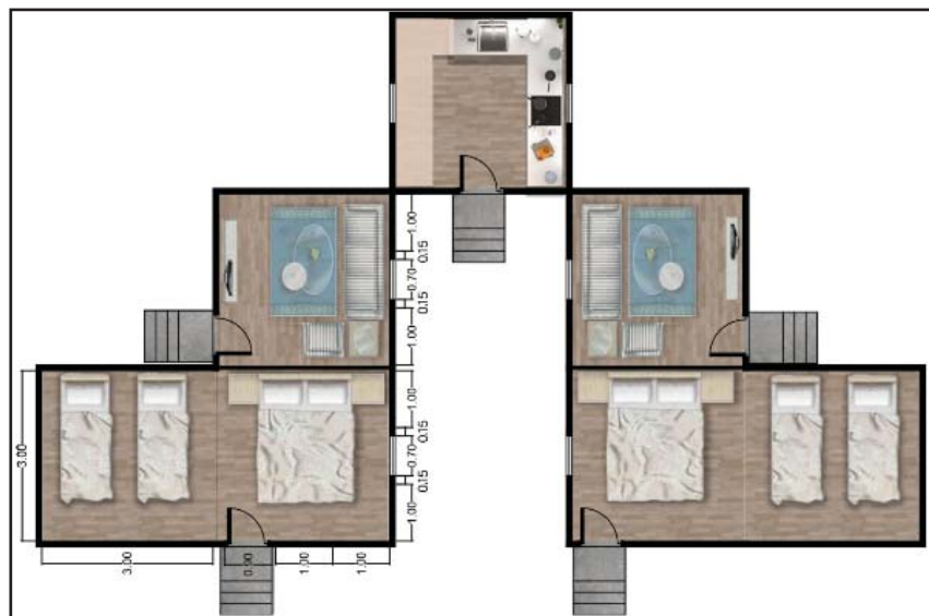
شکل ۱۵. پلان پیشنهادی برای دو خانواده ۴ نفره با نشیمن جدا و آشپزخانه مشترک مساحت ۶۳ متر مربع (نگارنده)
