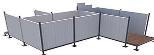
قرارگیری پانل‌های دیوار بعد از نصب پانل‌های داخلی (۴)
