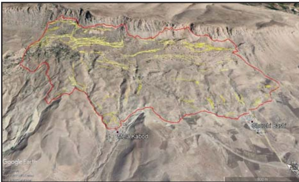
شکل ۱۱: تصویر ماهواره‌ای زمین لغزش مله‌کبود-قورچی‌باشی همراه با شکاف‌های عرضی و طولی پیاده شده بر روی آن با خطوط زرد رنگ (حق‌شناس و همکاران، ۱۳۹۶-ب).
