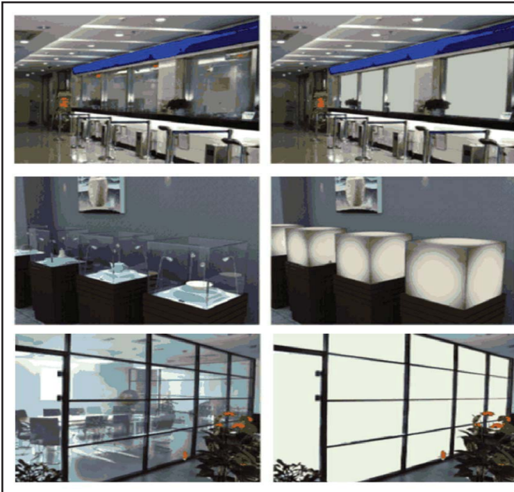
شکل ۴. عملکرد شیشه هوشمند الکتروکرومیک
