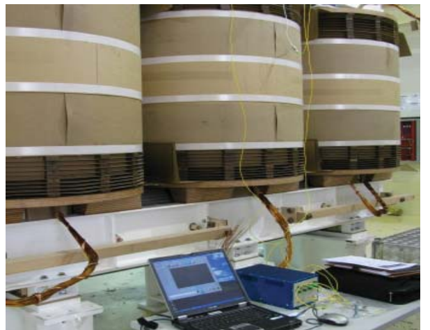
شکل ۱۱. استفاده از حسگرهای فیبری برای آشکارسازی و کنترل نقاط داغ در ترانسفورماتورهای برق (ریبیرو و همکاران، ۲۰۰۸)
