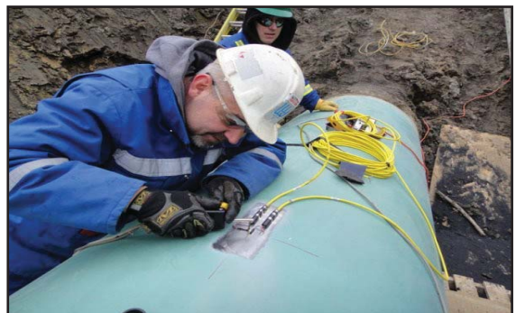
شکل ۵. استفاده از حسگر فیبر نوری در لوله‌های انتقال انرژی برای شناسایی محل شکستگی یا ترک خوردگی (اینائودی و گلیسیک، ۲۰۱۰)
