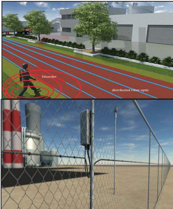
شکل ۶. استفاده از حسگرهای فیبری برای حفاظت از مناطق حساس و مهم (زاستاکوفسکی و زیسکوفسکی ۳ ، ۲۰۰۵)
